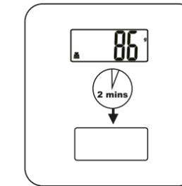
La balance s'éteindra automatiquement s'il y a aucune opération ou chargement de poids pendant deux minutes.
