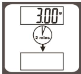
L'arrêt automatique de la balance s'active lorsque l'écran affiche « 0 » ou si le résultat d'une pesée demeure inchangé pendant deux minutes.
