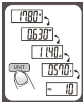
Appuyer sur le bouton « UNIT » pour procéder à la conversion de poids (gramme, once, dwt, ozt) et au pré-réglage de l'option de comptage de pièces.
