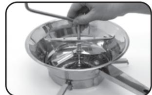
3. En exerçant une bonne pression vers le bas, insérer les deux crochets sous les attaches situées dans le moulin, de sorte que la poignée, le disque et le moulin soient fixés les uns aux autres.
