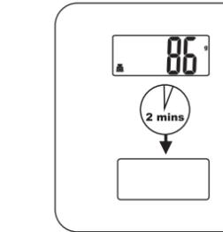
La balance s'éteindra automatiquement s'il n'y a aucune opération ou chargement de poids pendant deux minutes.
