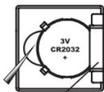
Retirer la pile à l'aide d'un objet pointu, tel qu'indiqué sur l'image.
