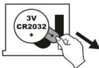
Nécessite une pile 3V au lithium (CR2032).
